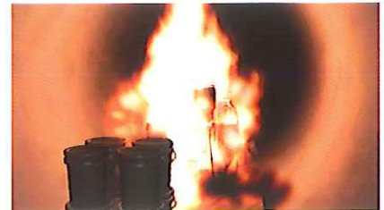
Risque accru d'incendie et d'explosion lors des travaux avec des peintures et des solvants dans un espace confiné.
