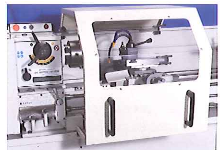
Les protections sur la machine ou autour de la machine empêchent tout accès à des zones dangereuses.
